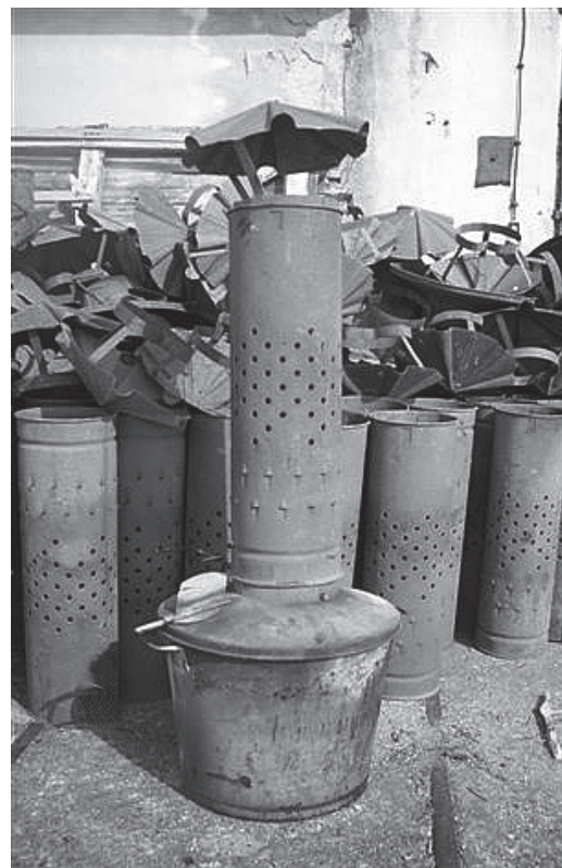
Największe zagrożenie dla winnicy w Polsce to wiosenny przymrozek. Na winnicy Saint Vincent w Borowie Wielkim rozstawia się w krytyczne dni specjalne grzejniki, spalające olej napędowy. Fot. Renata Wiśniewska
